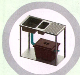
ติดตั้งถังดักไขมัน
